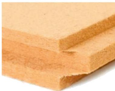
Los paneles aislantes térmicos de material de fibra de madera son productos muy respetuosos con el medio ambiente. El material de partida son fibras de madera de coníferas en bruto. Estos paneles machi-embrados, se usan para el aislamiento de las fachadas, proporcionando una base sólida y perfectamente sellada para la aplicación de un mortero acrílico.
