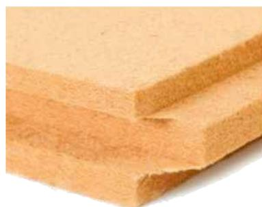
Les panneaux d'isolation thermique en fibre de bois sont très respectueux de l'environnement. Ils sont fabriqués à base de fibres de bois de conifères bruts. Ces panneaux rainurés-bouvetés sont utilisés pour l'isolation des façades et fournissent une base solide et parfaitement étanche pour l'application d'un mortier acrylique.
